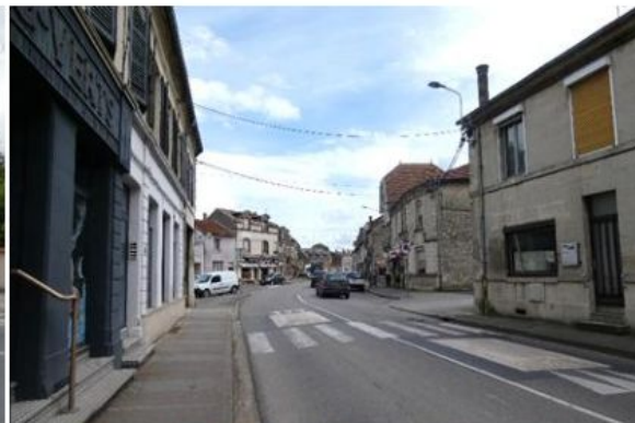
Absence d'abaissé sur le trottoir et de bandes podotactiles (Revigny-sur-Ornain)
